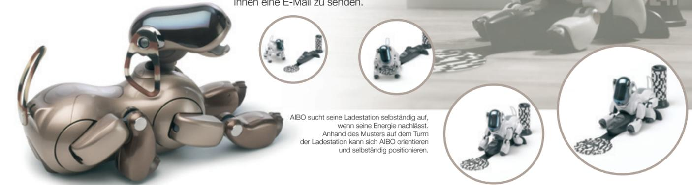
AIBO sucht seine Ladestation selbständig auf, wenn seine Energie nachlässt. Anhand des Musters auf dem Turm der Ladestation kann sich AIBO orientieren und selbständig positionieren.
