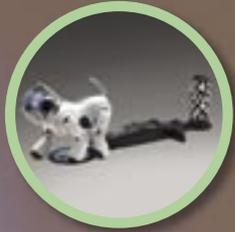
AIBO détecte automatiquement sa station de chargement lorsque sa batterie commence à faiblir.
