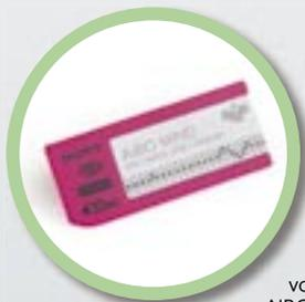
Un Memory Stick de 32 Mo intègre toutes les applications d'AIBO pour lui permettre d'être autonome et de bénéficier des applications spécifiques installées sur votre PC. Au fil du temps, AIBO peut ainsi acquérir de nouvelles compétences.
