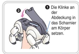
1 Die Klinke an der Abdeckung in das Scharnier am Körper setzen.
