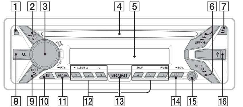
**1 Gumb za odstranjevanje sprednje plošče**
