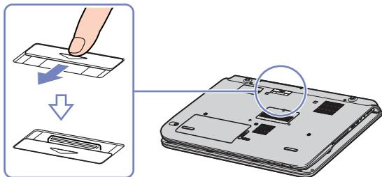
5 Placez la glissière de verrouillage en position **UNLOCK**.
