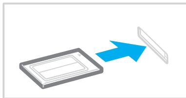
! Quando non si utilizza una PC Card, inserire la protezione per lo slot PC Card per proteggerlo dalla polvere. Prima di spostare il computer, assicurarsi di aver inserito la protezione nello slot per PC Card.
