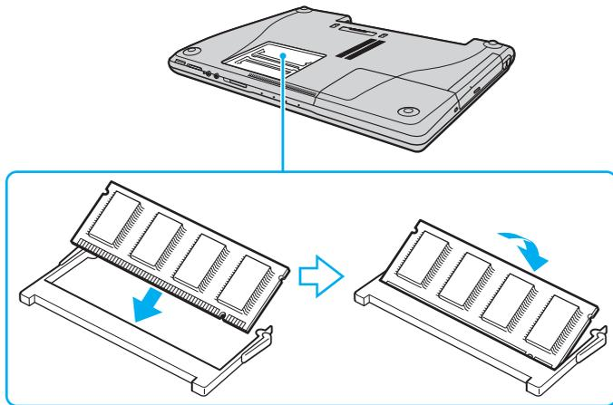
! Se si utilizza solamente un modulo di memoria, assicurarsi di inserirlo nello slot più vicino alla parte posteriore del computer.
