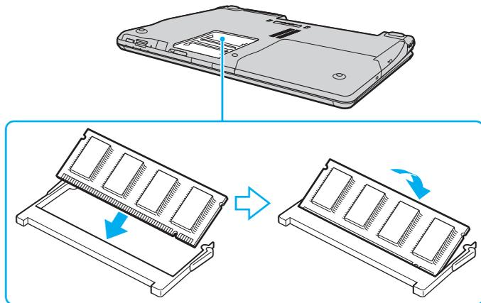
**!** Se si utilizza solamente un modulo di memoria, assicurarsi di inserirlo nello slot più vicino alla parte posteriore del computer.
