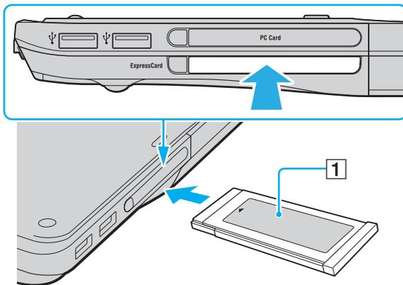
**!** Quando non si utilizza il modulo ExpressCard, inserire la protezione per lo slot ExpressCard in modo da proteggerlo dalla polvere. Prima di spostare il computer, assicurarsi di inserire la protezione nello slot per ExpressCard.
