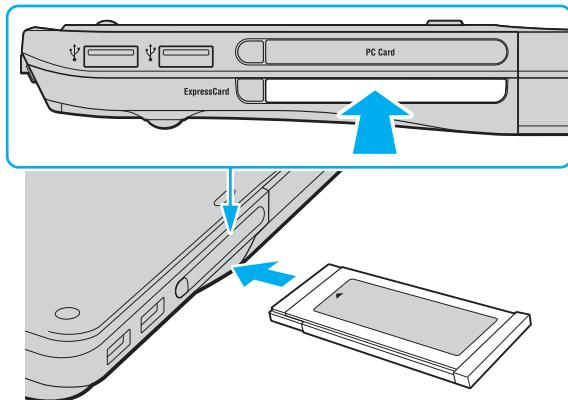
! Pokud modul ExpressCard nepoužíváte, vložte do patice kryt, který ji chrání proti vniknutí nečistot. Před přemístováním počítače nezapomeňte vložit do patice ExpressCard ochranný kryt.
