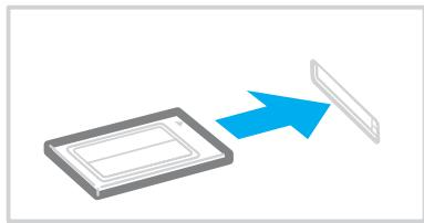
! Pokud kartu PC Card nepoužíváte, vložte do patice kryt, který ji chrání proti vniknutí nečistot. Před přemístováním počítače vždy vložte do patice PC Card ochranný kryt.
