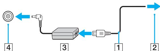
Tvar konektoru pro přívod stejnosměrného napájení se liší podle sít'ového adaptéru.
