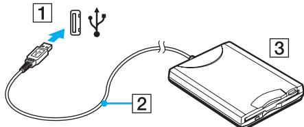
! Při práci s disketovou jednotkou USB nepůsobte na konektor USB silou. Mohlo by dojít k poruše.
