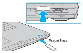
Tenez le support Memory Stick en orientant correctement la flèche et insérez-le dans l'emplacement prévu à cet effet. Si vous rencontrez une résistance en insérant le support Memory Stick, ne forcez pas afin de ne pas endommager l'ordinateur ou le support.
