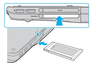
Insérez le capot de protection de l'emplacement ExpressCard afin de protéger l'emplacement de la poussière lorsque vous n'utilisez pas de support ExpressCard. Avant de déplacer l'ordinateur, veillez à bien réinsérer le capot de protection dans l'emplacement ExpressCard.
