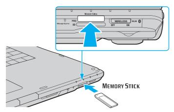
Ächten Sie beim Einsetzen des Memory Stick in den Steckplatz darauf, dass der Pfeil in die richtige Richtung zeigt. Wenn sich der Memory Stick nicht leicht einsetzen lässt, drücken Sie ihn auf keinen Fall mit Gewalt in den Steckplatz. Ihr Computer oder der Memory Stick könnte sonst beschädigt werden.
