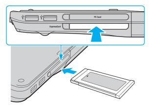
Setzen Sie die ExpressCard-Transportsicherung ein, um zu verhindern, dass Schmutz in den Steckplatz eindringt, wenn kein ExpressCard-Modul verwendet wird. Vergewissern Sie sich vor dem Transportieren des Computers, dass die Transportsicherung in den ExpressCard-Steckplatz eingesetzt ist.
