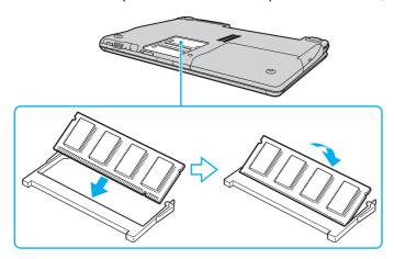
Wenn Sie nur ein Speichermodul verwenden, setzen Sie dieses in den Steckplatz ein, der näher an der Rückseite des Computers liegt.
