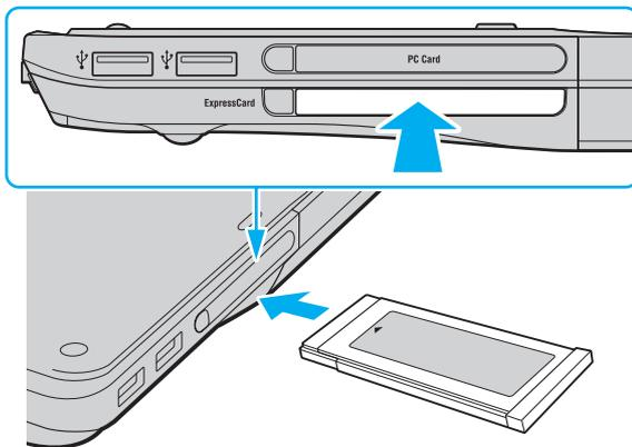
**!** Quando non si utilizza il modulo ExpressCard, inserire la protezione per lo slot ExpressCard in modo da proteggerlo dalla polvere. Prima di spostare il computer, è necessario inserire la protezione nello slot per ExpressCard.
