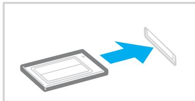
! Quando non si utilizza una PC Card, inserire la protezione per lo slot PC Card per proteggerlo dalla polvere. Prima di spostare il computer, accertarsi di aver inserito la protezione nello slot per PC Card.
