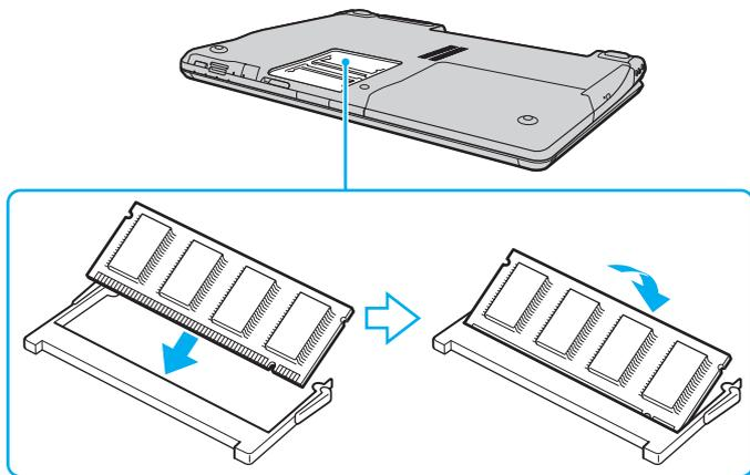
**!** Se si utilizza solamente un modulo di memoria, accertarsi di inserirlo nello slot più vicino alla parte posteriore del computer.
