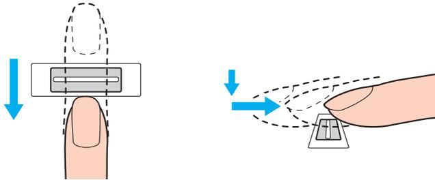
! Posizionare la punta del dito in posizione piatta al centro del sensore di impronte digitali.
