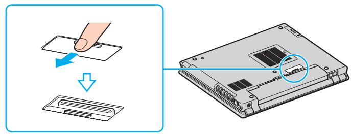
6 Positionnez le commutateur **LOCK/UNLOCK** de la station d'accueil de baie multifonction sur **UNLOCK**.
