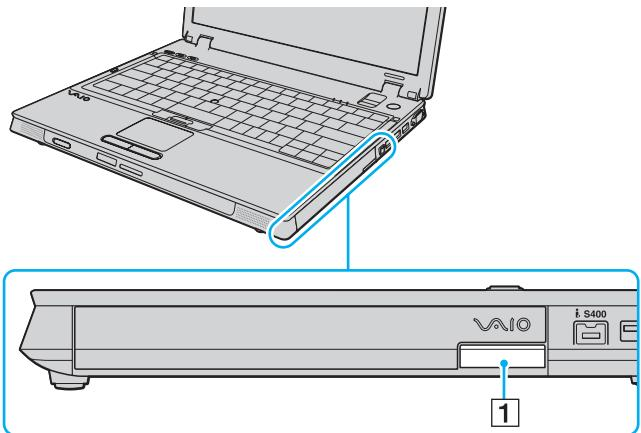
9 Аккуратно потяните кнопку для выталкивания установленного модуля.
