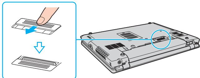
5 Сдвиньте переключатель **LOCK/UNLOCK** на установочной станции в положение **UNLOCK**.
