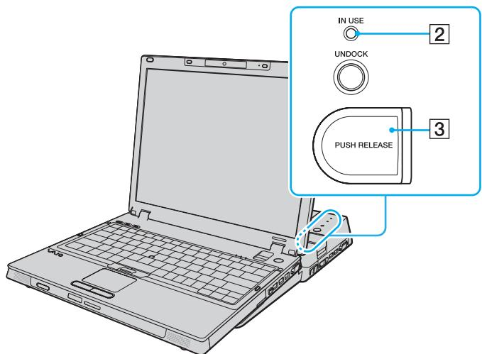
5 Извлеките компьютер из установочной станции.
