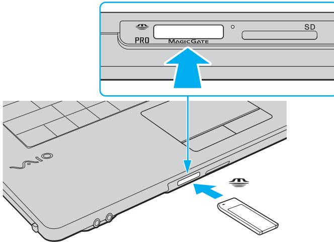
! Tenez le support Memory Stick en orientant correctement la flèche et insérez-le dans l'emplacement prévu à cet effet. Si vous rencontrez une résistance en insérant le support Memory Stick, ne forcez pas afin de ne pas endommager l'ordinateur ou le support.
