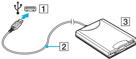
**!** Lors de l'utilisation d'un lecteur de disquettes USB, n'exercez aucune pression sur le port USB. Cela peut provoquer un dysfonctionnement.
