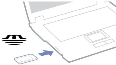
**!** Tenez le support Memory Stick et insérez-le, dans le sens indiqué par la flèche, dans l'emplacement prévu à cet effet. Pour ne pas endommager l'ordinateur ou le support Memory Stick, ne forcez pas le support Memory Stick dans son emplacement si vous rencontrez une résistance en l'insérant.
