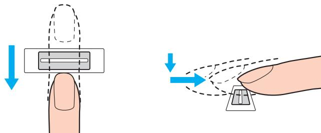
! Τοποθετήστε το δάκτυλό σας σε επίπεδη θέση στο κέντρο του αισθητήρα δακτυλικών αποτυπωμάτων.
