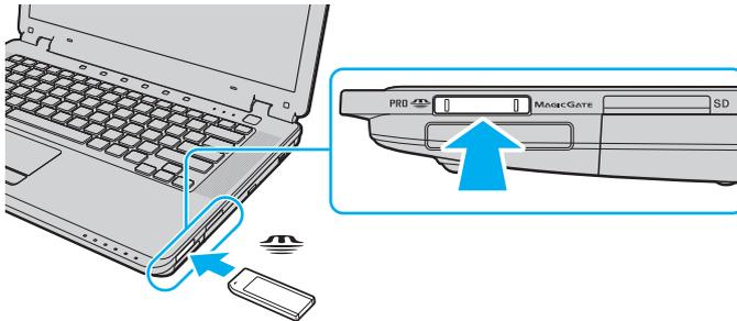
**!** Achten Sie beim Einsetzen des Memory Sticks in den Steckplatz darauf, dass der Pfeil in die richtige Richtung zeigt. Wenn sich der Memory Stick nicht leicht einsetzen lässt, drücken Sie ihn auf keinen Fall mit Gewalt in den Steckplatz. Ihr Computer oder der Memory Stick könnte sonst beschädigt werden.
