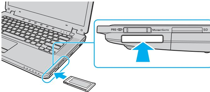
! Setzen Sie die ExpressCard-Transportsicherung ein, um zu verhindern, dass Schmutz in den Steckplatz eindringt, wenn kein ExpressCard-Modul verwendet wird. Vergewissern Sie sich vor dem Transportieren des Computers, dass die Transportsicherung in den ExpressCard-Steckplatz eingesetzt ist.
