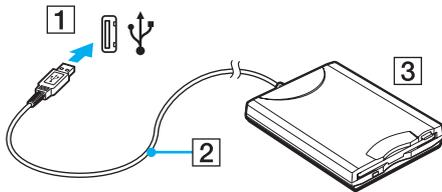
**!** Wenn Sie ein USB-Diskettenlaufwerk benutzen, darf der USB-Anschluss nicht mechanisch beansprucht werden. Dies kann zu einer Funktionsstörung führen.
