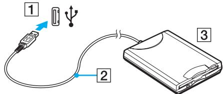
! Під час використання Пристрою USB зчитування дискет не застосовуйте силу до порту USB. Це може спричинити несправності.
