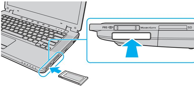
! Si no va a utilizar un módulo ExpressCard, inserte el protector en la ranura de ExpressCard para mantenerla protegida y evitar la entrada de suciedad. Antes de mover el ordenador, asegúrese de introducir el protector en la ranura para ExpressCard.
