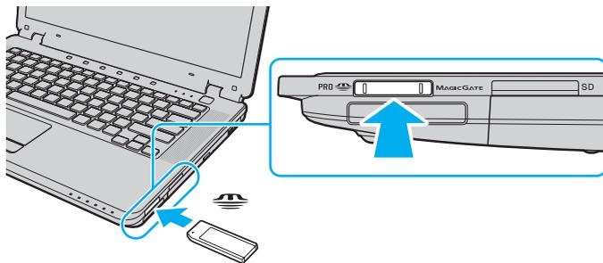
**!** Tenez le support Memory Stick en orientant correctement la flèche et insérez-le dans l'emplacement prévu à cet effet. Si vous rencontrez une résistance en insérant le support Memory Stick, ne forcez pas afin de ne pas endommager l'ordinateur ou le support.
