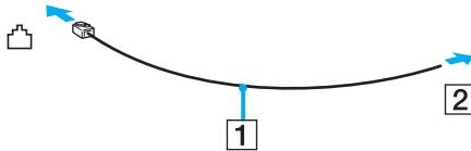
! Ihr Computer kann nicht an einen Gemeinschaftsanschluss, an Münzfernsprecher und an bestimmte Mehrfach- oder Nebenstellenanlagen (PBX) angeschlossen werden. Bei bestimmten Anschlussmöglichkeiten kann ein zu hoher elektrischer Strom fließen, der zu einer Fehlfunktion des internen Modems führen kann.
