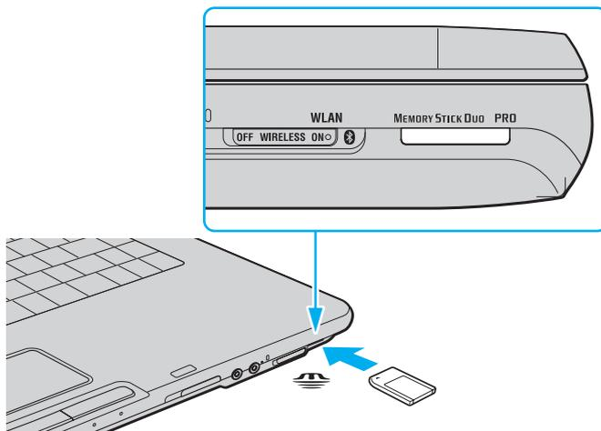
**!** Tenez le support Memory Stick en orientant correctement la flèche et insérez-le dans l'emplacement prévu à cet effet. Si vous rencontrez une résistance en insérant le support Memory Stick, ne forcez pas afin de ne pas endommager l'ordinateur ou le support.
