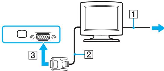
! Es necesario un dispositivo adaptador de vídeo para conectar un monitor VGA mediante un puerto DVI-D.
