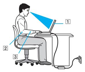
□ Posizione del computer: il computer deve essere posizionato esattamente di fronte all'utente (1). Quando si utilizza la tastiera, il touchpad o il mouse esterno, tenere gli avambracci orizzontalmente (2) e i polsi in posizione neutra e comoda (3). La parte superiore delle braccia deve scendere naturalmente lungo i fianchi. Non dimenticare di fare alcune pause durante le sessioni di lavoro al computer. L'utilizzo eccessivo del computer può provocare tensione agli occhi, ai muscoli e ai tendini.
