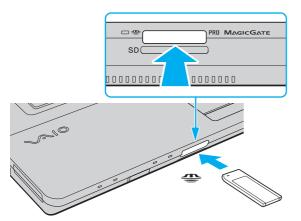
Quando si inserisce il supporto Memory Stick nello slot, mantenere la freccia puntata nella direzione corretta. Per evitare di danneggiare il computer o il supporto Memory Stick, non forzare quest'ultimo se l'inserimento nello slot risultasse difficile.
