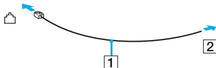
! Non è possibile utilizzare il computer con linee in duplex. Inoltre, non può essere collegato ad apparecchi telefonici pubblici e può non funzionare correttamente con linee telefoniche multiple o centralini privati (PBX). Alcuni collegamenti potrebbero determinare un flusso di corrente elettrica eccessivo, danneggiando il modem incorporato.
