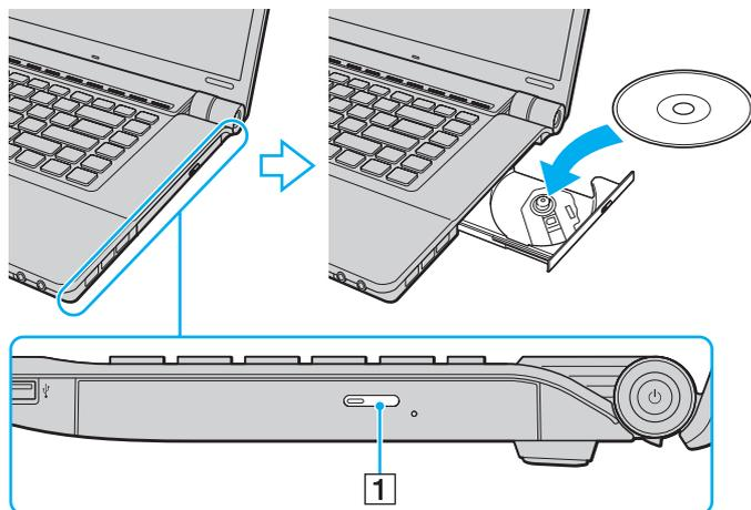
**!** Non esercitare pressione sul vassoio dell'unità. Assicurarsi di sostenere la parte inferiore del vassoio dell'unità durante l'operazione di inserimento/rimozione di un disco.
