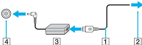
! A forma da tomada DC In depende do transformador.
