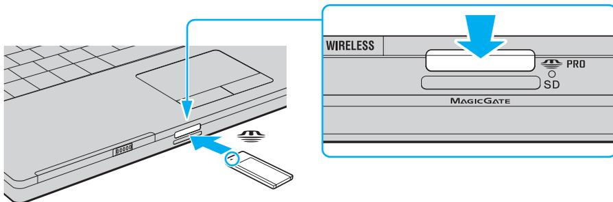
! Certifique-se de que segura o suporte Memory Stick com a seta virada para cima na direcção correcta quando o inserir na ranhura. Para evitar danificar o computador ou o suporte Memory Stick, não o force na ranhura, caso não o consiga inserir suavemente.
