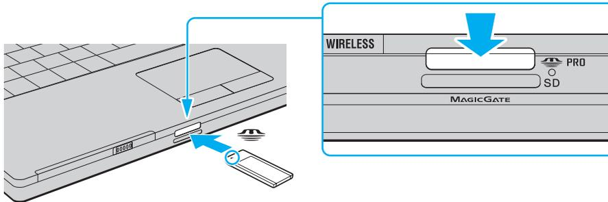
**!** Quando si inserisce il supporto Memory Stick nello slot, mantenere la freccia puntata nella direzione corretta. Per evitare di danneggiare il computer o il supporto Memory Stick, non forzare quest'ultimo se l'inserimento nello slot risultasse difficile.
