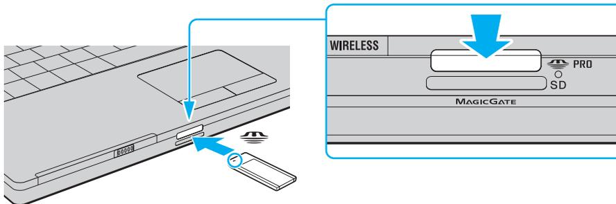
**!** Achten Sie beim Einsetzen des Memory Stick in den Steckplatz darauf, dass der Pfeil in die richtige Richtung zeigt. Wenn sich der Memory Stick nicht leicht einsetzen lässt, drücken Sie ihn auf keinen Fall mit Gewalt in den Steckplatz. Ihr Computer oder der Memory Stick könnte sonst beschädigt werden.
