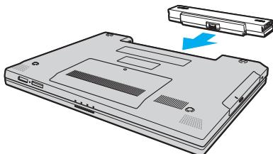
4 Pro zabezpečení akumulátoru v počítači posuňte zámek akumulátoru (1) do polohy **LOCK**.
