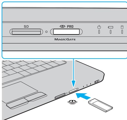
! Quando si inserisce il supporto Memory Stick nello slot, mantenere la freccia puntata nella direzione corretta. Per evitare di danneggiare il computer o il supporto Memory Stick, non forzare quest'ultimo se l'inserimento nello slot risultasse difficile.
