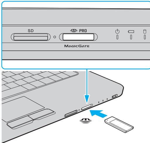
! Achten Sie beim Einsetzen des Memory Sticks in den Steckplatz darauf, dass der Pfeil in die richtige Richtung zeigt. Wenn sich der Memory Stick nicht leicht einsetzen lässt, drücken Sie ihn auf keinen Fall mit Gewalt in den Steckplatz. Ihr Computer oder der Memory Stick könnte sonst beschädigt werden.
