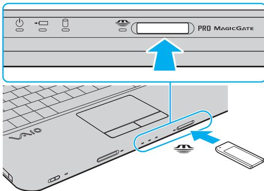
**!** Certifique-se de que segura o Memory Stick com a seta virada para cima na direcção correcta quando o inserir na ranhura. Para evitar danificar o computador ou o Memory Stick, não o force na ranhura, caso não o consiga inserir suavemente.
