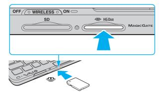
Quando si inserisce "Memory Stick" nello slot, mantenere la freccia puntata nella direzione corretta. Per evitare di danneggiare il computer o il supporto, non forzare "Memory Stick" se l'inserimento nello slot risultasse difficile.
