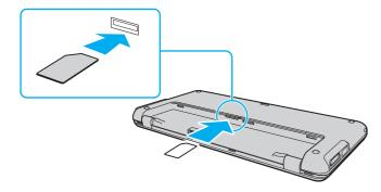
! Non toccare il circuito della scheda SIM. Accertarsi di tenere saldamente il computer prima di inserire o rimuovere la scheda. Non danneggiare la scheda SIM in alcun modo, piegandola o esercitando pressione su di essa.
