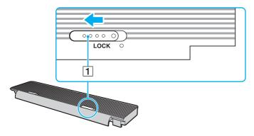
Inserire la batteria nel relativo alloggiamento.
