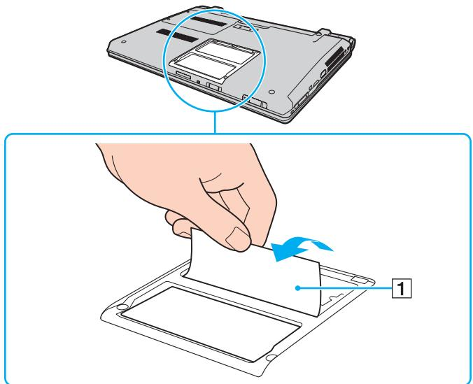
! Изолирующий чехол предназначен для защиты модуля. Не тяните слишком сильно, чтобы не повредить чехол.
