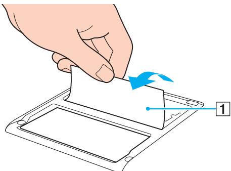
! Ізоляційне покриття призначається для захисту модуля. Не витягуйте його занадто сильно, щоб не пошкодити покриття.
