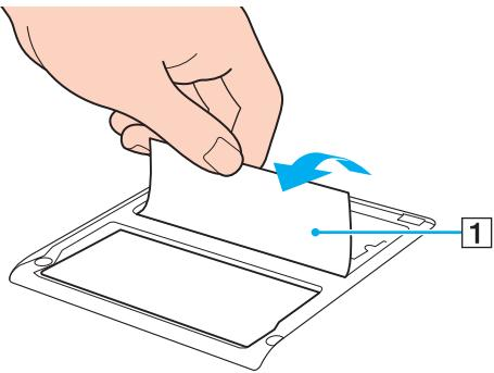
! Изолирующий чехол предназначен для защиты модуля. Не тяните слишком сильно, чтобы не повредить чехол.
