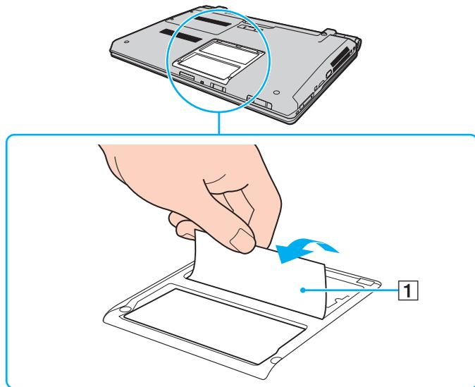
! La lamina isolante viene fornita per la protezione del modulo. Non tirarla in modo brusco per evitare di danneggiarla.
