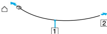
! Non è possibile utilizzare il computer con linee in duplex. Inoltre, non può essere collegato ad apparecchi telefonici pubblici e può non funzionare correttamente con linee telefoniche multiple o centralini privati (PBX). Alcuni collegamenti potrebbero determinare un flusso di corrente elettrica eccessivo, danneggiando il modem integrato.
