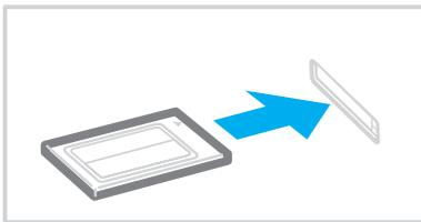
! Quando non si utilizza una PC Card, inserire la protezione per lo slot PC Card per proteggerlo dalla polvere. Prima di spostare il computer, accertarsi di inserire la protezione nello slot per PC Card.
