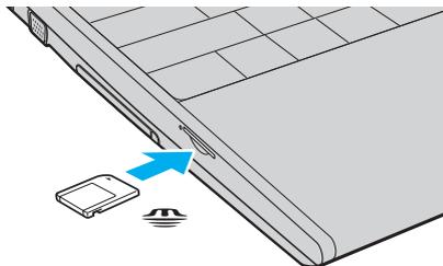
! Quando si inserisce il supporto Memory Stick nello slot, mantenere la freccia puntata nella direzione corretta. Per evitare di danneggiare il computer o il supporto Memory Stick, non forzare quest'ultimo se l'inserimento nello slot risultasse difficile.
