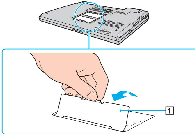
**!** La lamina isolante viene fornita per la protezione del modulo. Non tirarla in modo brusco per evitare di danneggiarla.
