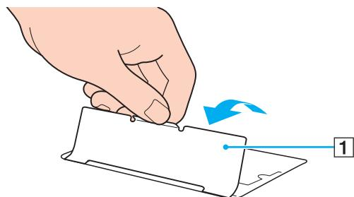
! Изолирующий чехол предназначен для защиты модуля. Не тяните слишком сильно, чтобы не повредить чехол.
