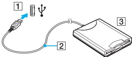
**!** При работе с USB дисководом гибких дисков не прикладывайте усилий к порту USB. Это может вызвать неполадки в работе компьютера.
