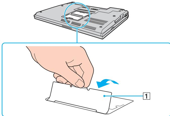
**!** Изолирующий чехол предназначен для защиты модуля. Не тяните слишком сильно, чтобы не повредить чехол.
