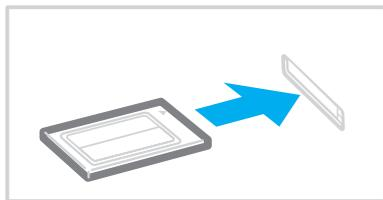
! Если карта PC Card не используется, вставьте в гнездо PC Card защитное устройство, которое препятствует попаданию в гнездо пыли и грязи. Перед перемещением компьютера обязательно вставьте заглушку в гнездо PC Card.
