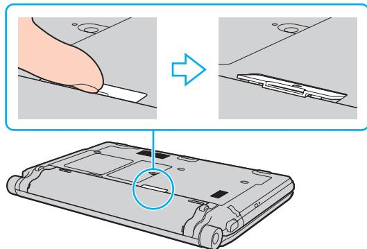
! Кришка міцно з'єднується із комп'ютером і при її від'єднанні можуть виникати труднощі. Не застосовуйте надмірної сили при знятті кришки, щоб не пошкодити комп'ютер або кришку розніму док-станції.
