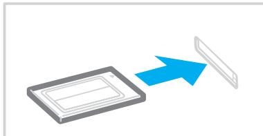
! Insérez le capot de protection afin de protéger l'emplacement de carte PC Card de la poussière lorsque vous n'utilisez pas de carte PC Card. Avant de transporter l'ordinateur, veillez à bien insérer le capot de protection de l'emplacement de carte PC Card dans son emplacement.
