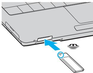
**!** Tenez le support Memory Stick en orientant correctement la flèche et insérez-le dans l'emplacement prévu à cet effet. Si vous rencontrez une résistance en insérant le support Memory Stick, ne forcez pas afin de ne pas endommager l'ordinateur ou le support.
