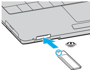
**!** Quando si inserisce il supporto Memory Stick nello slot, mantenere la freccia puntata nella direzione corretta. Per evitare di danneggiare il computer o il supporto Memory Stick, non forzare quest'ultimo se l'inserimento nello slot risultasse difficile.
