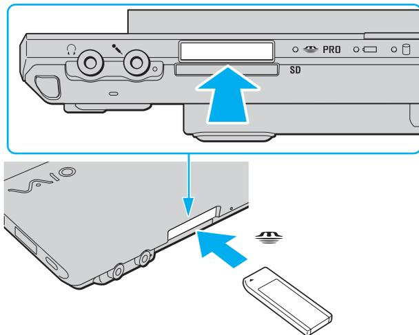
! Tenez le support Memory Stick en orientant correctement la flèche et insérez-le dans l'emplacement prévu à cet effet. Si vous rencontrez une résistance en insérant le support Memory Stick, ne forcez pas afin de ne pas endommager l'ordinateur ou le support.
