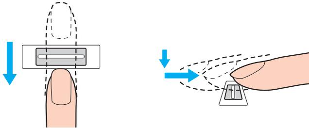
! Coloque la yema del dedo en el centro del sensor de huellas dactilares.
