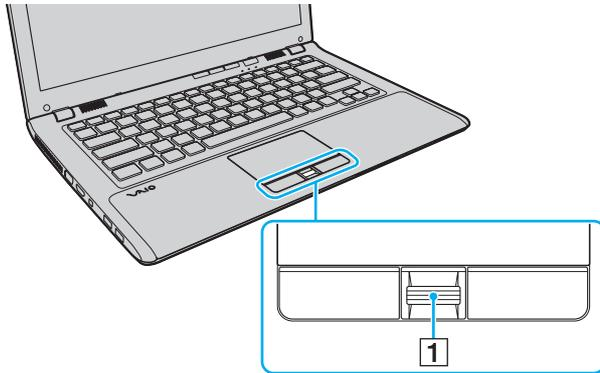
2 Pase el dedo de forma perpendicular por el sensor de huellas dactilares.
