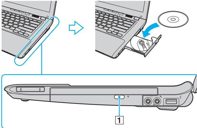
! No ejerza presión sobre la bandeja de la unidad. Asegúrese de sujetar la parte inferior de la bandeja de la unidad cuando coloque o quite un disco de la bandeja.
