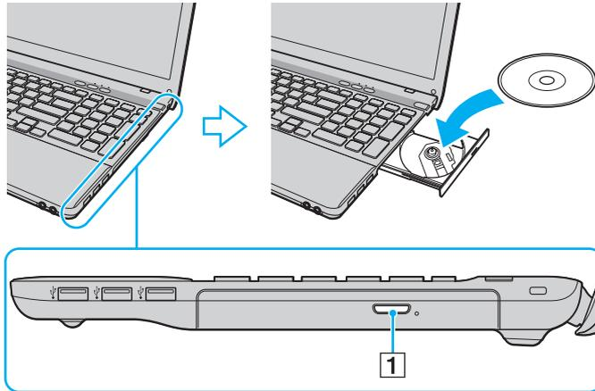
! Não exerça pressão sobre o tabuleiro da unidade. Certifique-se de que apoia a parte inferior do tabuleiro da unidade com uma mão quando colocar ou remover um disco do tabuleiro.
