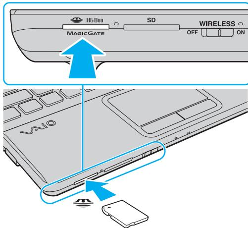
! Antes de utilizar um suporte “Memory Stick Micro” (“M2”), introduza-o num adaptador “M2” Duo. Se inserir o suporte directamente na ranhura para suportes “Memory Stick Duo” sem o adaptador, poderá não conseguir removê-lo da ranhura.
