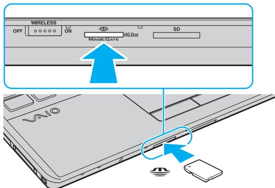
! Setzen Sie unbedingt Memory Stick Micro-Speichermedien (M2) in einen M2 Duo-Adapter ein. Falls Sie die Speichermedien ohne den Adapter direkt in den Memory Stick Duo-Steckplatz einsetzen, können Sie sie unter Umständen nicht wieder herausnehmen.
