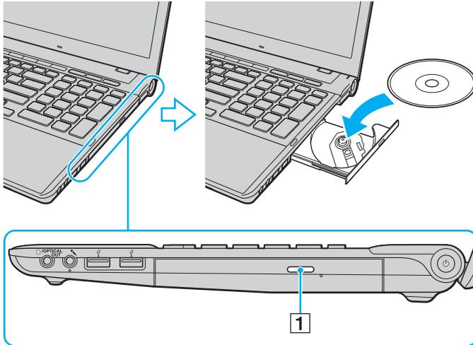
! Üben Sie keinen Druck auf die Laufwerksschublade aus. Halten Sie unbedingt die Unterseite der Schublade fest, wenn Sie Discs einlegen oder herausnehmen.
