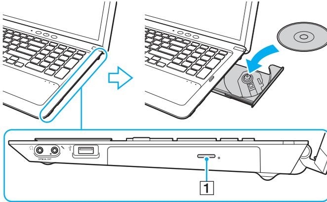
**!** No ejerza presión sobre la bandeja de la unidad. Asegúrese de sujetar la parte inferior de la bandeja de la unidad cuando coloque o quite un disco de la bandeja.
